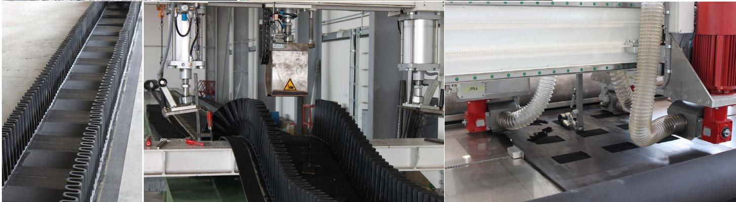
**#3** Maßgebend für die Qualität und Lebensdauer eines Wellenkantengurtes, ist die Festigkeit der Verbindung der Komponenten zum Basisfördergurt. Durch den Einsatz unseres Hochleistungsklebstoffes der germanBond® - Produktlinie und die Verarbeitung mit unseren hochmodernen Produktionsanlagen, mit denen die Montage der Komponenten automatisiert und mit maschineller Präzision erfolgt, kann die erforderliche Verbindungsfestigkeit gewährleistet werden.
